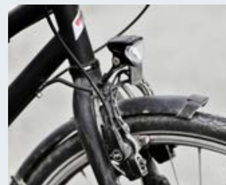
Die hydraulische HS 22 von Magura bremst schnell und zuverlässig.
