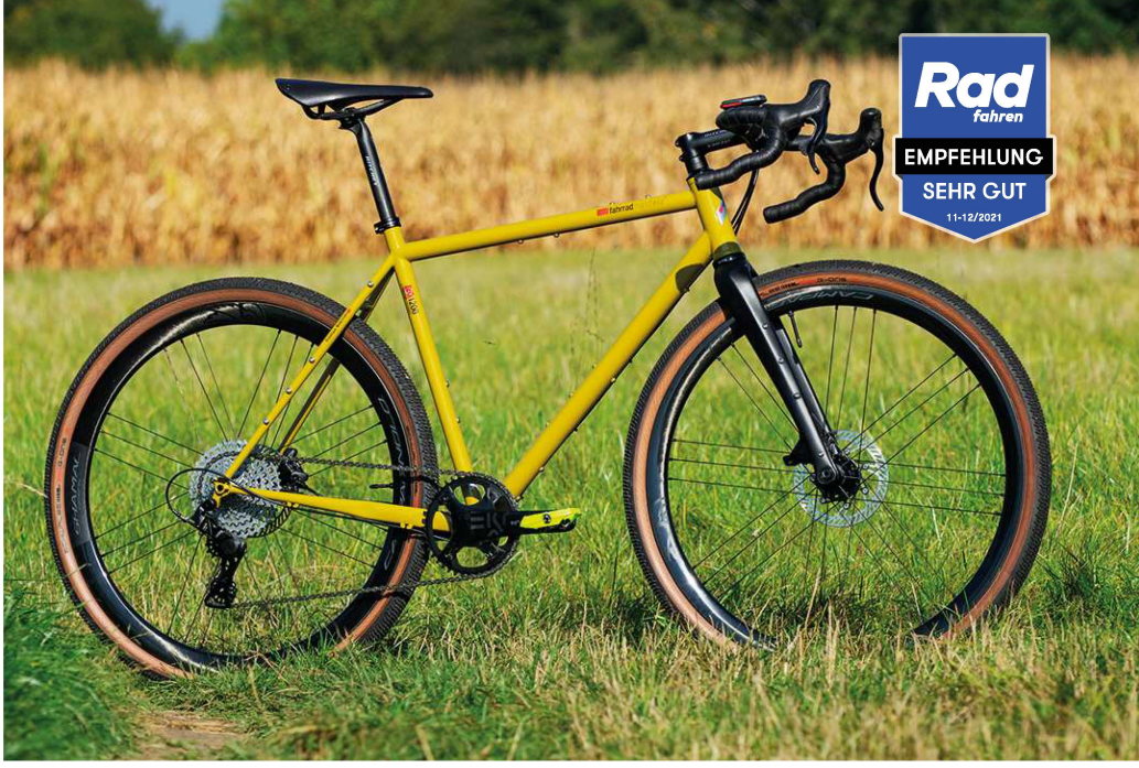
Gelb auf Stahl geschrieben: das Testrad ist der Erbkönig. Unten: Nobles Ekar-Schaltwerk und progressive 13er-Kassette.
