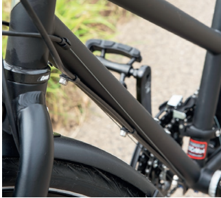
Deore-Schaltung und -Bremsen, mit kurzem Hebel. Unten: Klassische, einfach zugängliche Zugverlegung am Stahlrahmen.
