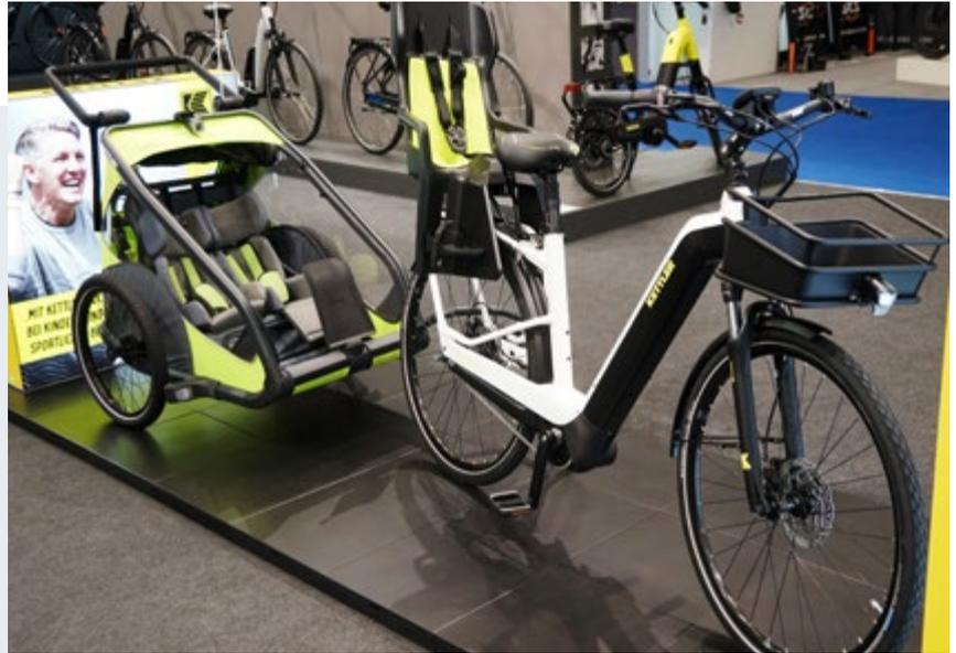
Und sie konzipierten einen Kinderanhänger mit interessanten Features wie: ausfahrbares Bugrad, verdeckte Federung, herausnehmbare Tasche, Licht-Stecksystem. Dessen Kupplung formschlüssig in einen bereits im Rahmen integrierten Adapter greift. Ach ja, der sympathische Herr im Hintergrund ist Kettlers neuer Markenbotschafter: Sebastian Schweinsteiger.
