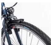
umlaufender Kettenkasten. Unten: Selten & klasse: hydraulische Felgenbremsen mit roten Gummis.
