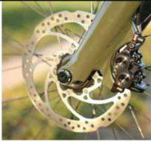
Magura MT Thirty Bremse: präzise zupackend und gut dosierbar.
