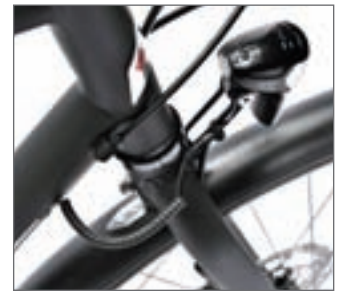
Schön schlicht: muffenloser Rahmen und außen verlegte Züge.
